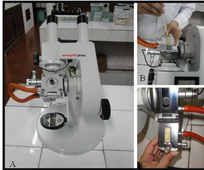
Figura 2: Determinação do teor de SST: A. Refratômetro Analytkjena®; B e C. Aplicação da amostra.
