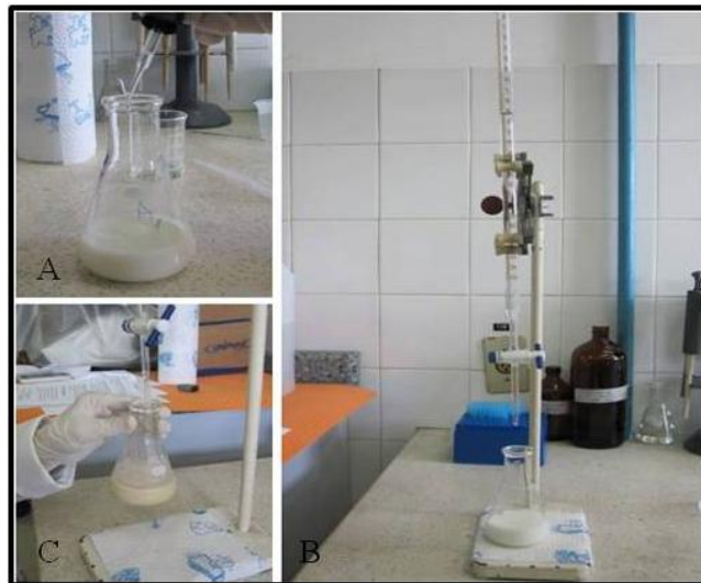
Figura 5: Determinação da acidez em ácido láctico: A. Adição da fenolftaleína às amostras; B. e C. Titulação com hidróxido de sódio 0,1M.
