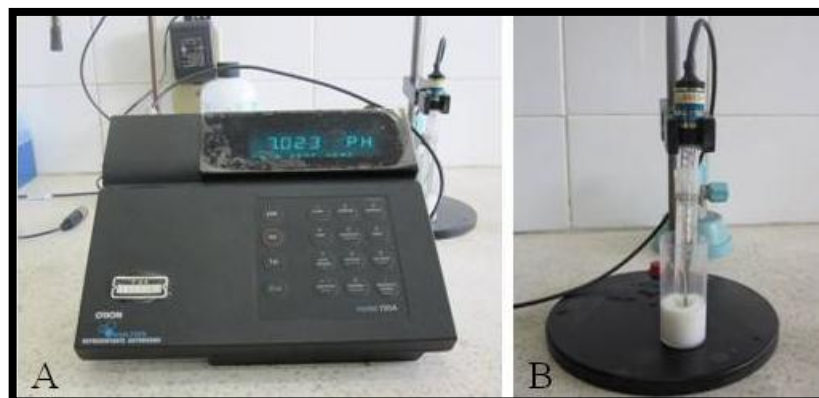
Figura 3: Determinação do pH: A. Analisador de íons ORION® 720 a ; B. Leitura da amostra.
