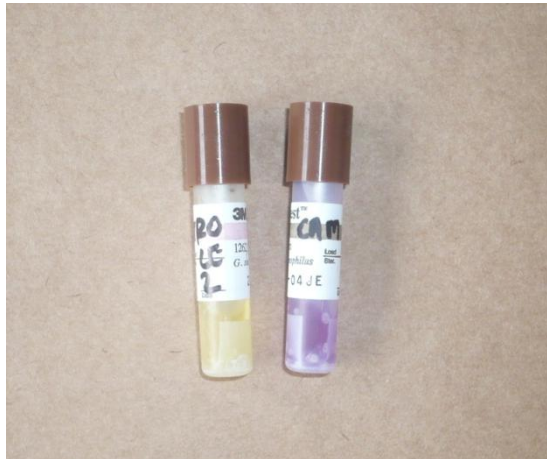
Figura 2 - Duas ampolas, uma de cor amarela, indicando o controle após 48 horas na estufa. Ao lado uma ampola com o resultado eficaz de autoclavagem.
